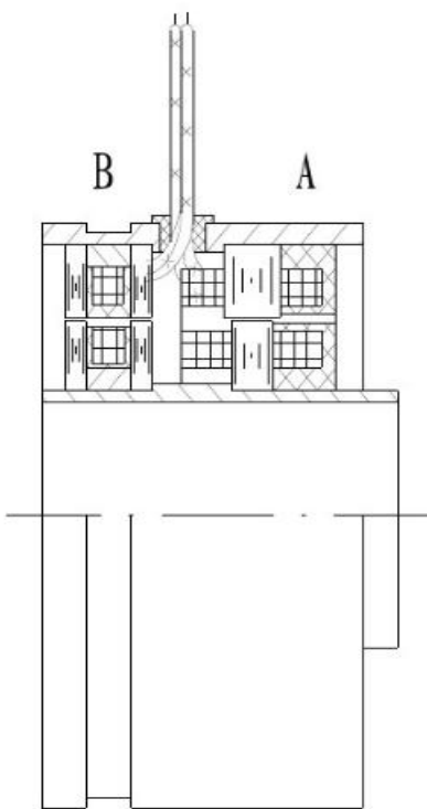
图 1、环形变压器式旋变结构示意图
